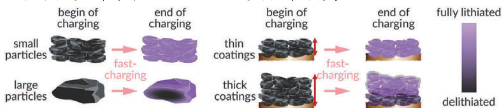
圖四、小/大尺寸活性材料和薄/厚負極塗層厚度於快充過程中的鋰化程度。
