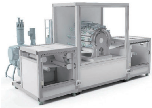
圖 13. SALD 設計之 R2R ALD 概念圖，可以每秒 3 公尺的速度進行 ALD 鍍膜 24 。
