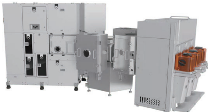
圖 12. Applied Picosun Sprinter™ 單晶圓 ALD 系統，其層流式反應腔設計有效避免副反應生成，即使於 90 °C 低溫條件下沉積 \text{Al}_2\text{O}_3 亦可保持均勻性，顯示其優異之薄膜一致性與穩定性，適用於高介電膜層及多孔碳基電極材料修飾 23 。
